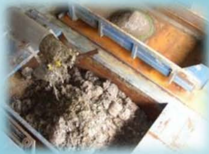
Déchets solides des canalisations récupérés à la station d'épuration
